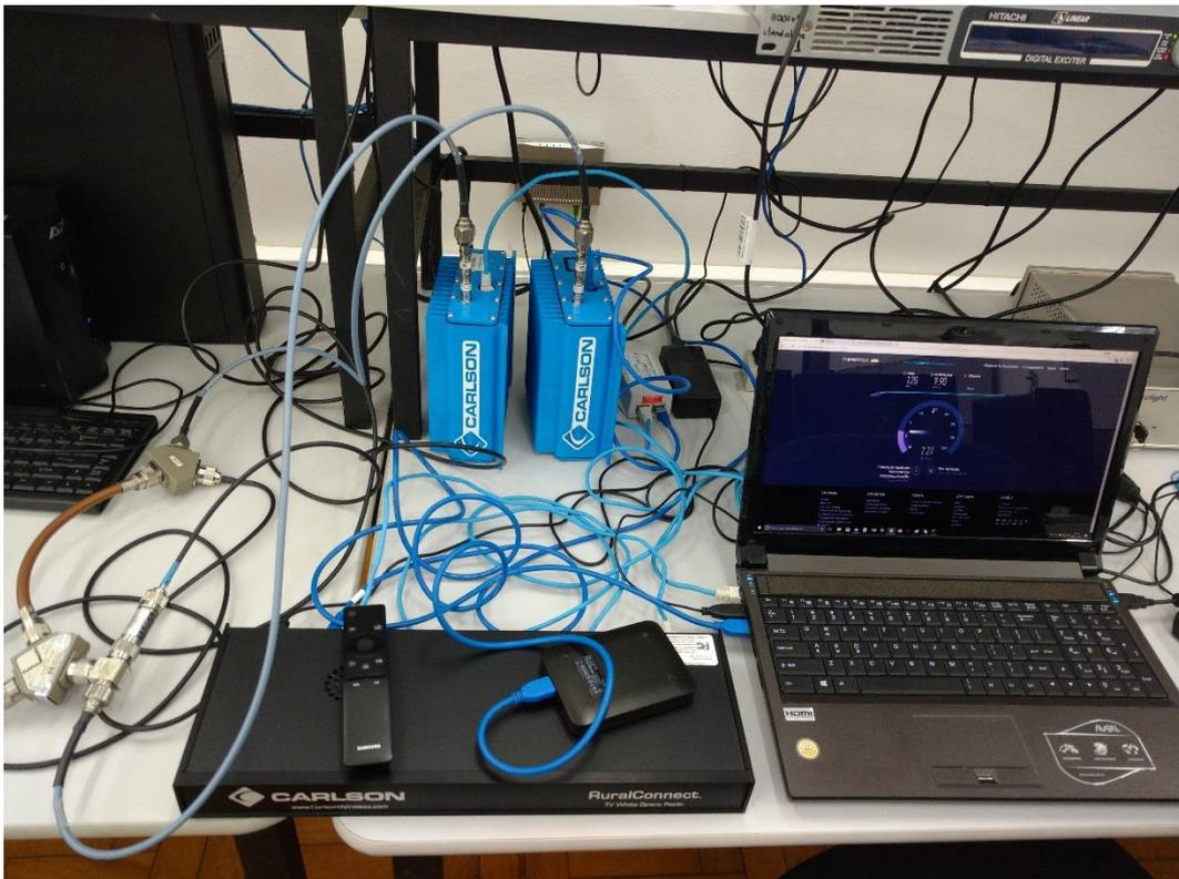
Figura 13: Montagem do sistema com Radio White Space, na bancada do laboratório do Centro de Referência em Radiocomunicações
