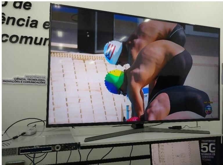
Figura 16: Imagem TVD sendo exibida no canal 34 UHF, durante teste de convivência
